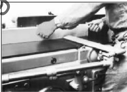
Фигура 31 – Рендосване на дъски
