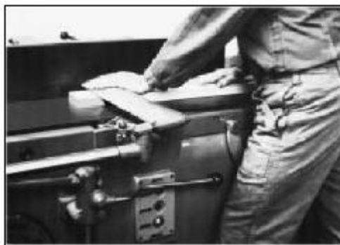
Фигура 29 – Рендосване на повърхност
