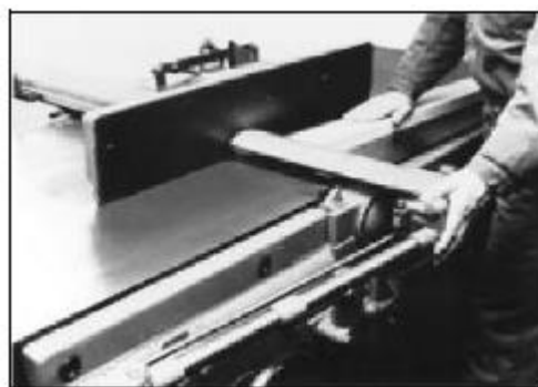
Фигура 28 – Регулиране на предпазителя
