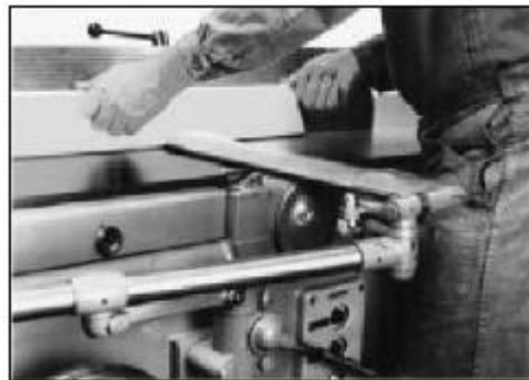
Фигура 35 – Рендосване с водач, наклонен под ъгъл от 45°
