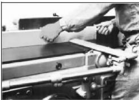
Фигура 32 – Рендосване на по-дебели детайли
